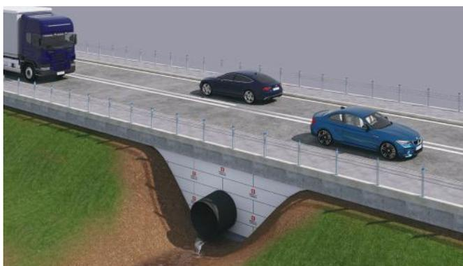
**Figure 3** Remplissage pour protéger les conduites souterraines, les installations de drainage et les infrastructures soumises à des charges verticales élevées.
