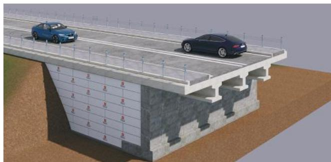
**Figure 2** Prévention des tassements dans les structures d'approche des ponts et les talus sur des surfaces de sol mou.
