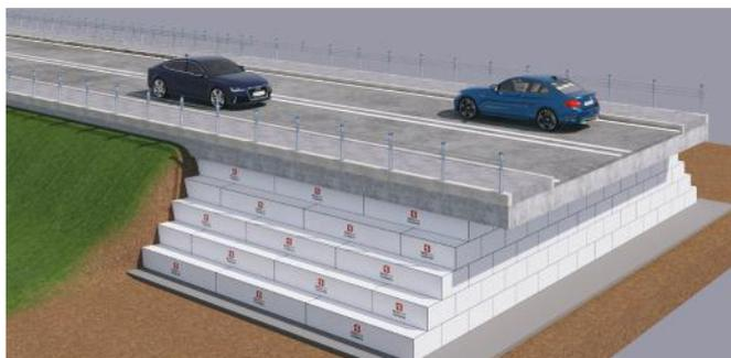
**Figure 1** Utilisation de remblai de terre au lieu du remblai de terre utilisé dans les autoroutes, les ponts et les rampes d'accès, ce qui allège la charge de conception.
