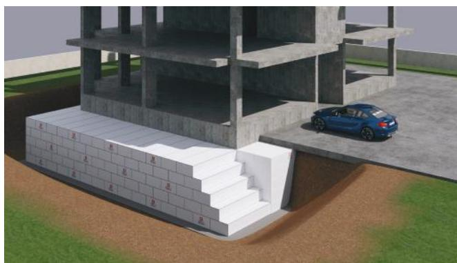
**Figure 4** Applications de remplissage pour réduire les charges sismiques latérales dans les structures de soutènement et les fondations.
