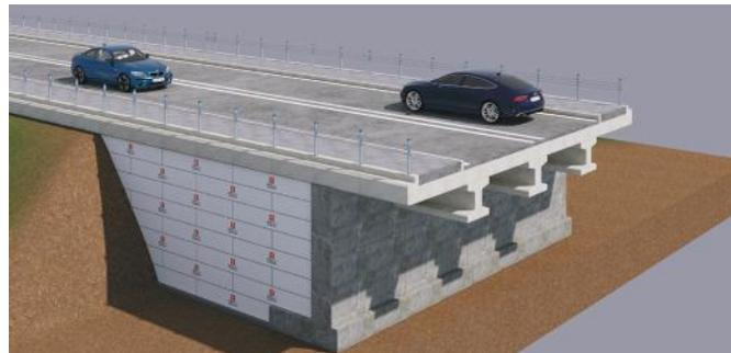
**Abbildung 2** Vermeidung von Setzungen bei Brückenanfahrtskonstruktionen und Hangauffüllungen auf weichem Boden.
