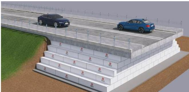
**Abbildung 1** Anwendung zur Reduzierung der Designlast im Vergleich zur Erdfüllung, die bei Straßen, Brücken und Rampen verwendet wird.
