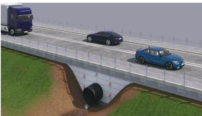
**Abbildung 3** Füllung zum Schutz von unterirdischen Rohrleitungen, Entwässerungs- und Infrastruktureinrichtungen, die hohen vertikalen Lasten ausgesetzt sind.
