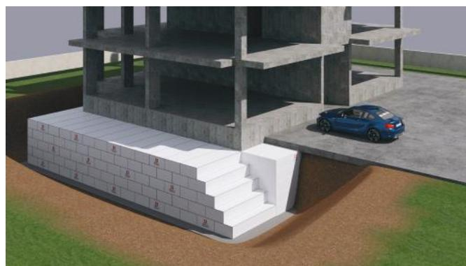
**Abbildung 4** Füllanwendungen zur Verringerung der seitlichen Erdbebenlasten auf Stützwänden und Fundamenten.
