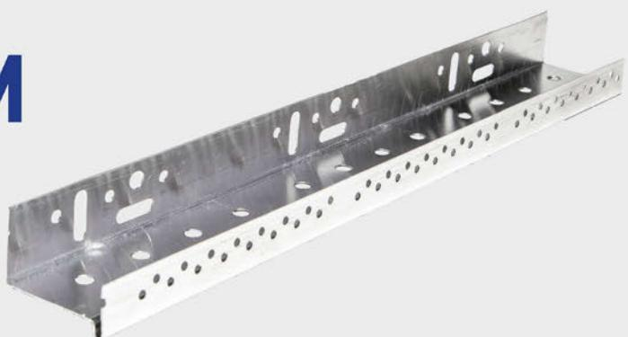
Teknosistem Subasman profili, ısı yalıtım levhalarının doğru ve düzgün bir şekilde monte edilebilmesi için referans düzlemi olarak ve mantolama sistemini darbelerden korumak amacıyla kullanılır. Genişlikleri, yalıtım kalınlığına bağlı olarak değişen alüminyum esaslı profillerdir.
