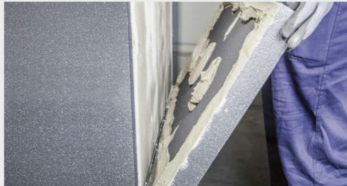
Teknosistem Grafit Teknopor EPS ısı yalıtım levhası, genleştirilmiş polistiren sert köpük, %98'i hava ve %2'si petrol türevi plastikten oluşan termoplastik, kapalı gözenekli, üretimi sırasında eklenen grafit katkısıyla kızıl ötesi emicilik ve yansıtıcılık özelliği kazanarak, ısı iletkenlik katsayısının büyük oranda azalmasını sağlar. Gri renkli, ısı yalıtım değeri diğer EPS ürünlerine göre daha yüksek, ekonomik ve hafif bir ısı yalıtım malzemesidir.
