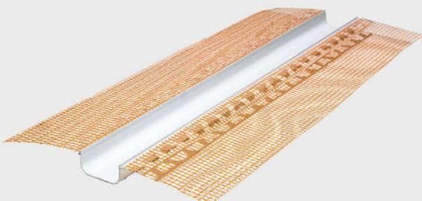
Mantolama sistemleri üzerine düzgün ve hızlı bir şekilde fugalar oluşturmak, ısı yalıtım levhaları üzerinde açılmış olan fuga bölgelerinin geçişlerinde kullanmak veya son kat kaplama uygulamasıyla dekoratif bir görüntü elde etmek için PVC esaslı Teknosistem Fuga Profilleri kullanılır. Fuga profili, üzerine hazır yapıştırılmış donatı filesiyle işçilik ve zamanдан tasarruf edilmesini sağlar, olası işçilik hatalarını engeller.
